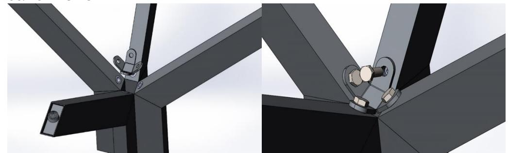
3. Далее откройте столешницу и поднимите поворотный механизм, чтобы прикрутить болты M8x40 к собранной опоре
